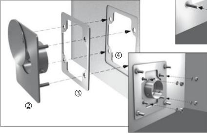
Nun die Aufnahme für das FSE ② zusammen mit der Adapterplatte ③ mit der zuvor montierten Halterung ④ verschrauben.
