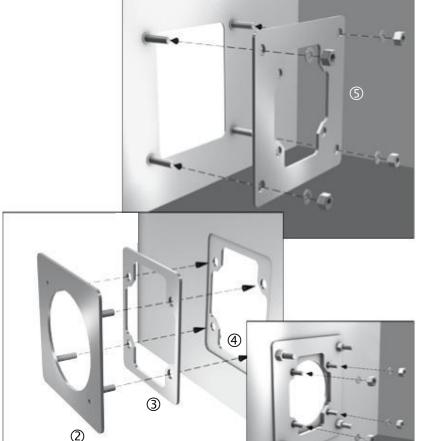
Zunächst die Halterung für das FSE PZ ① von innen an die Säule montieren. Dazu die im Lieferumfang enthaltenen Muttern und Unterlegscheiben verwenden.
